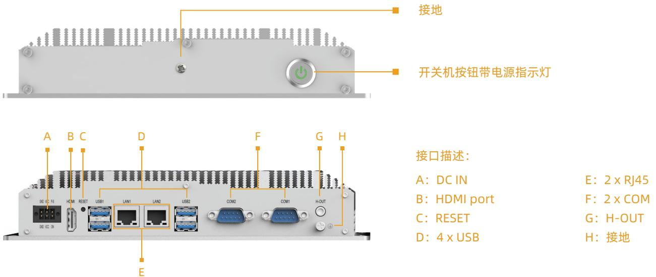
③ 处理器为Intel® Core™ 10/11/12/13代 i3/i5/i7的iBOX22XX系列无风扇工控机 接口部分如下所示：
